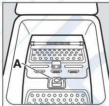
**ВНИМАНИЕ!** Перед закрыванием крышки стиральной машины проверьте, чтобы барабан был закрыт как следует:
